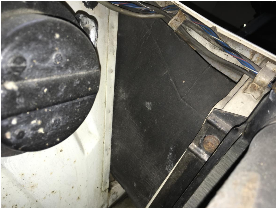
Original papp-plate ved siden av radiatoren!
